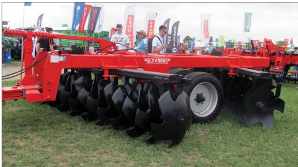
Дисковая борона Флео-Флео позволяет равномерно перемешивать почвенный горизонт по всей глубине обработки, распределяя пожнивные остатки или органические удобрения
