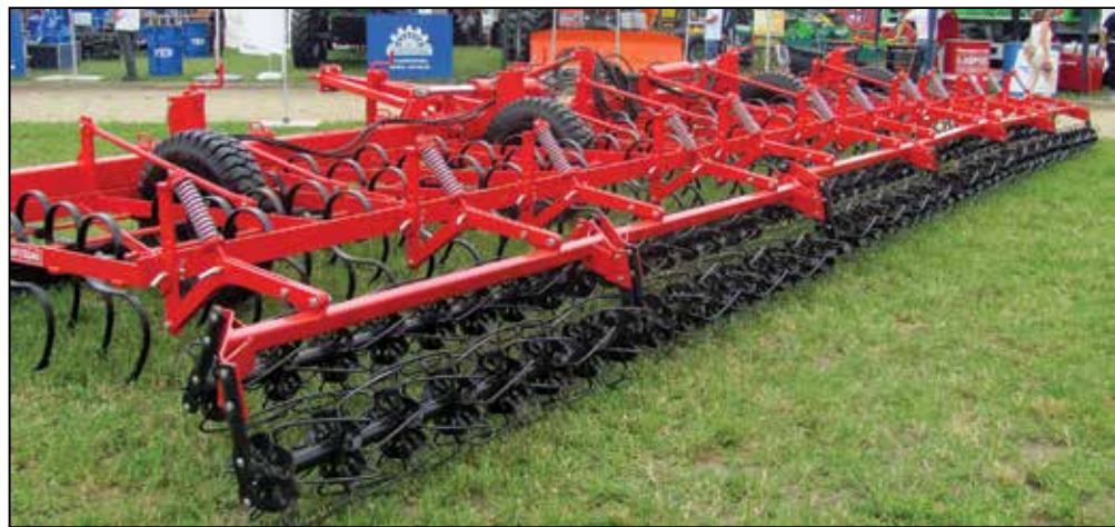
Культиватор QUIVOGNE прекрасно подходит для сплошной предпосевной обработки почвы
