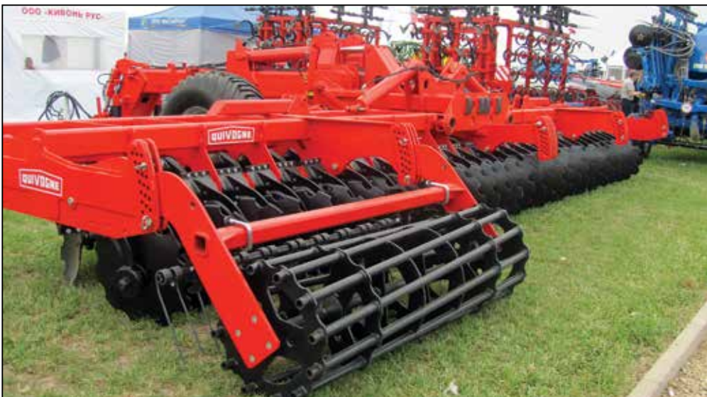
Дискатор SL-800 предназначен для качественной заделки растительных остатков и подготовки поля с минимальными потерями влаги
