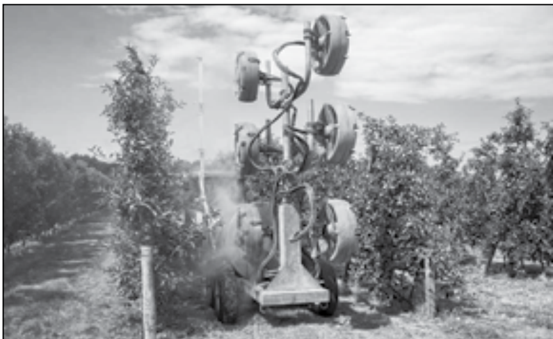
Исследователи из Корнеллского университета показывают, как установка серии ультразвуковых датчиков на опрыскиватель позволяет получать информацию о просветах в кронах деревьев и, управляя вентилятором, снижать скорость воздушного потока
