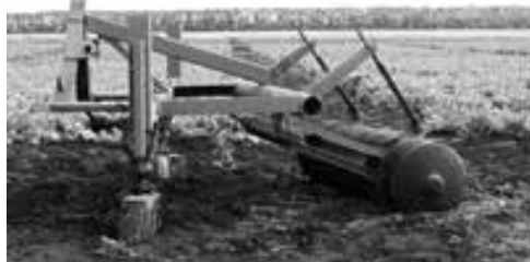
Рис. 1. Экспериментальное скашивающее устройство
