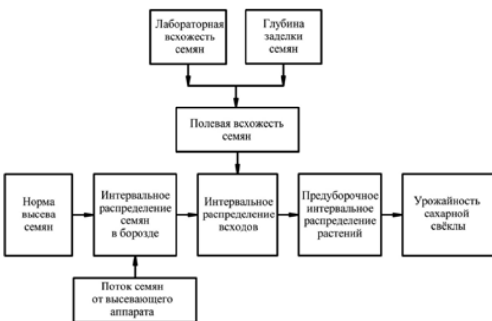
Рис. 2. Структурная схема имитационной модели технологии возделывания сахарной свёклы
