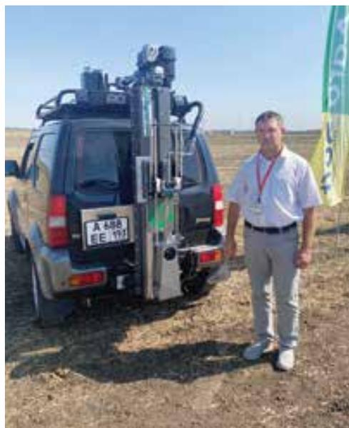
Пробоотборник не выходит за допустимые габариты ТС и легко снимается вне сезона почвенного отбора. Отбор почв осуществляется с помощью спирального сверла, конструкция которого обеспечивает равномерный отбор почвы по высоте пахотного горизонта 30 см. Компания «Агро-Софт» более 10 лет занимается зональным почвенным отбором и оказывает услуги по зональному отбору, в том числе на рисовых чеках.
