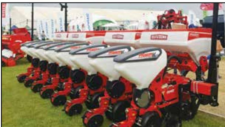
Сеялка точного высева для сева пропашных культур PROSEM Basic Fix
