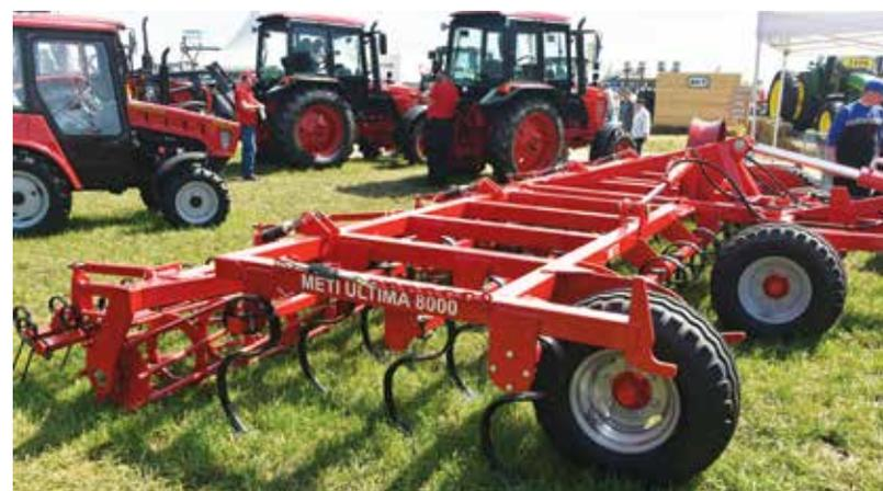
Кроме качественного выполнения непосредственно технологических операций конструкцией предусмотрено и удобство транспортировки. Культиваторы с шириной захвата до 10 м включительно компактно складываются в транспортное положение. Ширина орудий в таком положении составляет 2,5 м, высота — 3,9 м, соответственно, для передвижения по дорогам общего пользования не нужно никаких дополнительных согласований.
