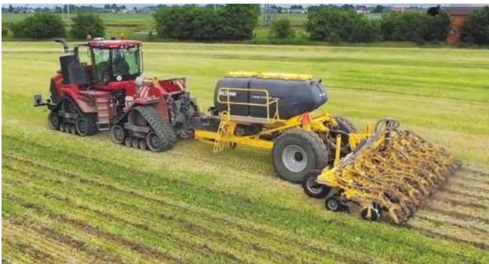
Двухкамерный прицепной бункер имеет 2 ёмкости для сыпучих продуктов (два вида удобрений/удобрения и семена) объёмами 3000 и 2000 л. Работа осуществляется под давлением. Это техническое решение позволяет повысить точность дозирования, особенно для удобрений, которые распределяются труднее.
