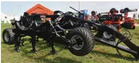
В «Кивонь РУС» хорошо представлены также стерневые культиваторы. Одна из машин экспонировалась на стенде - BLACKBEAR. Рабочий орган этого тяжелого сельхозорудия – долото с крыльями позволяет работать на глубине до 27 см. Его особенность в том, что у него стоят полуотвалы, т. е. при работе происходит частичный оборот пласта. Машина популярна в Центральной России, и сейчас активно представляем ее возможности и в ЮФО в ходе демпоказов, поскольку прежде она сюда не завозилась.
