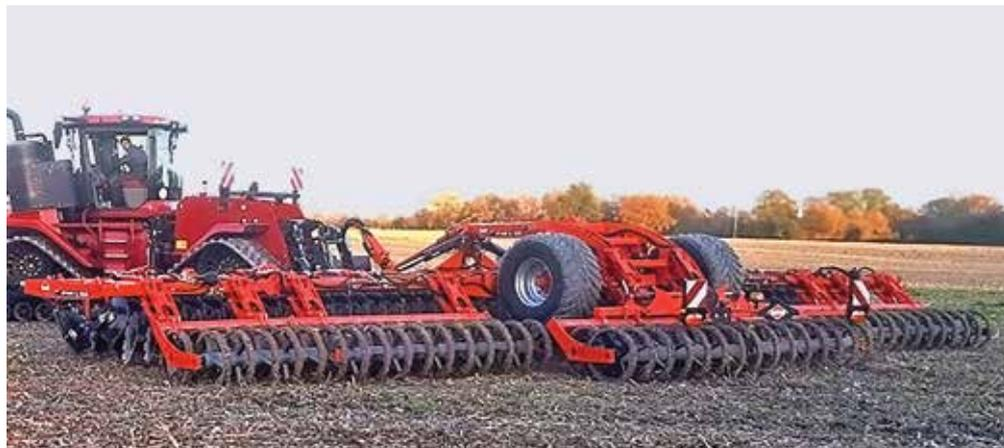
Steady Control обеспечивает установку глубины обработки по всей ширине захвата независимо от рельефа и регулировку из кабины трактора.
