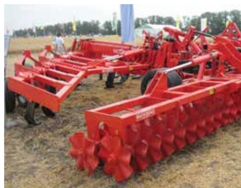
Итак, прицепной глубокорыхлитель V-SUB. Он снабжен как лапами, так и катком, – отметил представитель «Кивонь РУС». – Подобные машины применяются в том числе и в России, но у них каток опорный, а у нас – нет. Осенью обработка почвы сопровождается осадками, и, когда влажный грунт поднимается за лапой, это не дает дискам работать. Поскольку у V-SUB каток не опорный, его можно отстегнуть и работать чисто лапами, рыхлитель не будет заваливаться.
