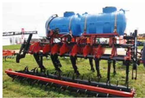
– Мы же располагаем именно прицепными глубокорыхлителями, что очень удобно для тех хозяйств, у которых большие поля и, соответственно, работают трактора мощностью больше 400 л. с. В этом плане Quivogne вне конкуренции.
