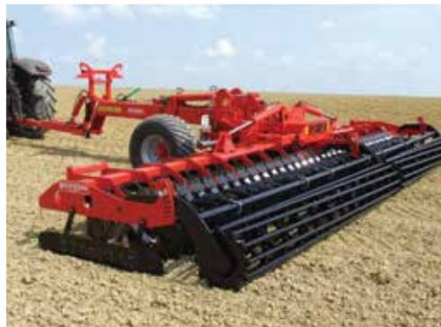
Дискаторы могут агрегатироваться с различными видами катков – от простых клиновидных до тандемных трубчато-планчатых. Отличная заделка растительных остатков и мгновенное обратное уплотнение почвы прикатывающим катком обеспечивают быстрое гниение соломы и сохраняют запас влаги в почве. Точно выдерживая глубину обработки, эта машина идеально измельчает пожнивные остатки и подготавливает посевное ложе.
