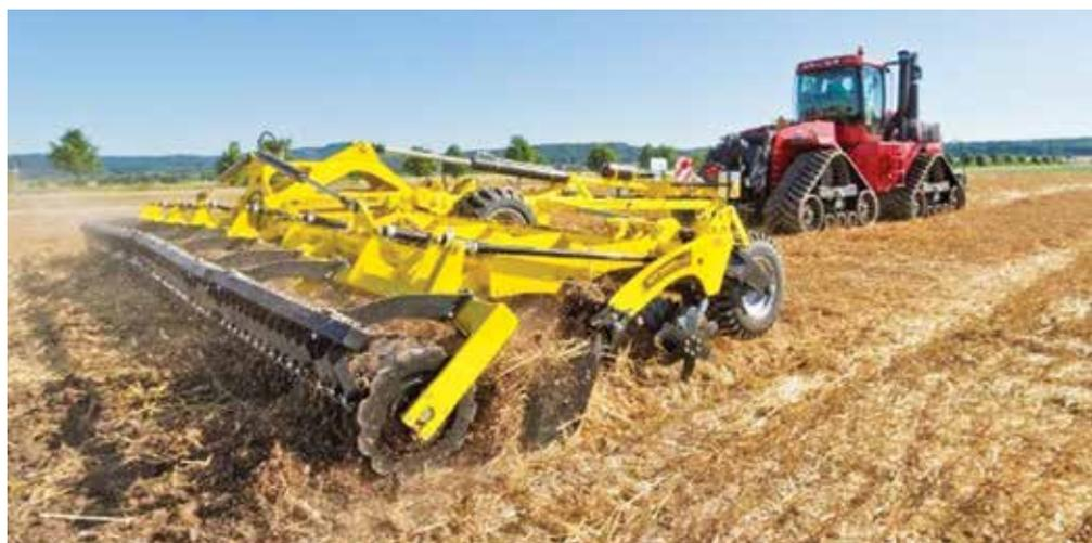
Механизаторы, которые работают с дисковым лущильником **SWIFTERDISC XE**, отмечают его маневренность и компактность в сложенном состоянии, быстрое перемещение по дорогам в габарите трактора: транспортная ширина составляет всего 3 метра.
