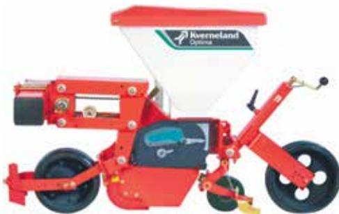
Секция HD II используется для традиционного, мульчированного сева на глубину до 9 см. Ёмкость бункера для семян составляет 55 л. Точный контроль глубины сева осуществляется благодаря независимым опорным каткам диаметром 410 мм, шириной 120 мм на маятниковой подвеске.
