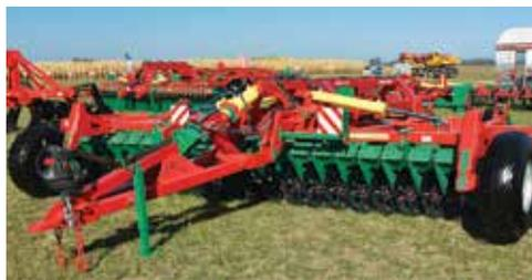
Луцильник способен работать как на большой глубине (15 см) для выполнения тяжёлых работ, так и успешно себя показывает на мелкой глубине. Предназначен для уничтожения сорняков, измельчения пожнивных остатков, создания на поверхности мульчированного слоя. Орудие укомплектовано диском Drop диаметром 560 мм, обеспечивающим оптимальное крошение сухой почвы и препятствующим забиванию дисков при работе в сырых условиях. Рабочая скорость при этом составляет до 20 км/ч.
