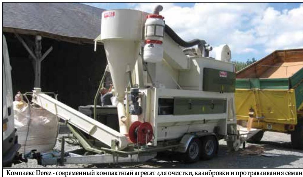
Комплекс Dorez - современный компактный агрегат для очистки, калибровки и протравливания семян
