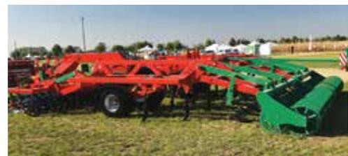
Агрегат дисколаповый «Бизон» предназначен для сплошной обработки почвы на глубину до 35 см ее рыхлением, выравниванием и прикатыванием, измельчением пожнивных остатков и уничтожением корневой системы сорных растений.
