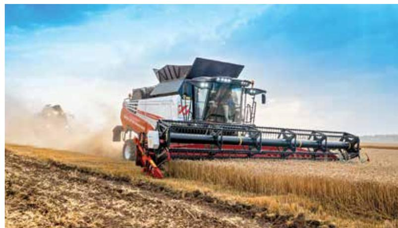
На TORUM 785 используется электрогидравлическая система копирования рельефа почвы. Неровности поля компенсируются при помощи «копиров» и гидроцилиндров подъемной наклонной камеры, что позволяет сократить потери зерна.
