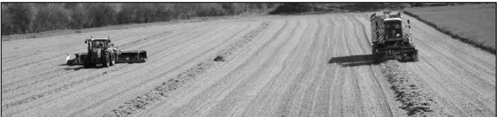
Рис. 12. Уборка сенажа по технологии STF 12 м. Комбайн загружает полуприцеп на своей задней полураме
