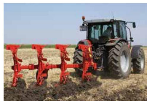
Плуги лемешные оборотные ПЛО «ВАРЯГ» с количеством корпусов 3-1; 3; 3+1 предназначены для вспашки различных почв, в том числе слабокаменистых. Производят гладкую вспашку челночным способом без свальных и развальных борозд. Для этого имеют право- и левооборотные корпуса, образующие плужную пару.
