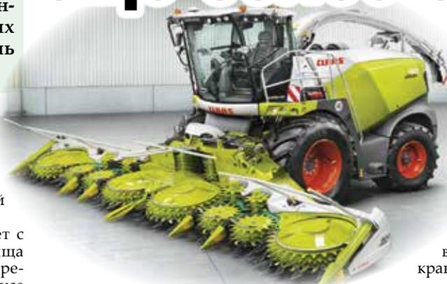
расхода горючего также достигается благодаря автоматическому снижению оборотов двигателя во время разворота на краю поля.
