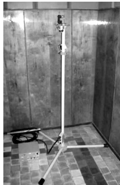
Фото. 1. Лазерная технологическая установка ЛУ-2 с полупроводниковым модулем
