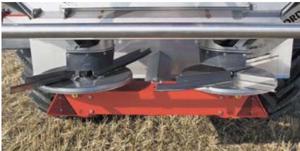
Точность на долгое время: SULKY широко использует нержавеющую сталь и высокопрочное покрытие для лопаток
