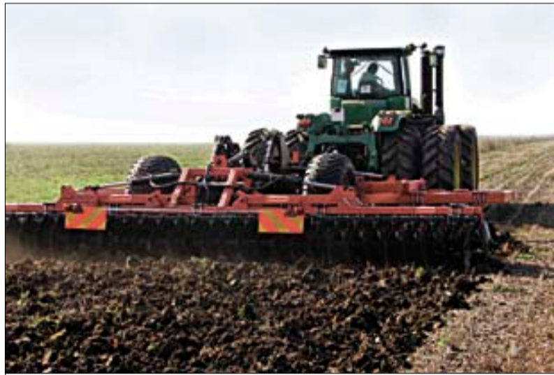
Широкозахватный навесной глубокорыхлитель DIABLO
