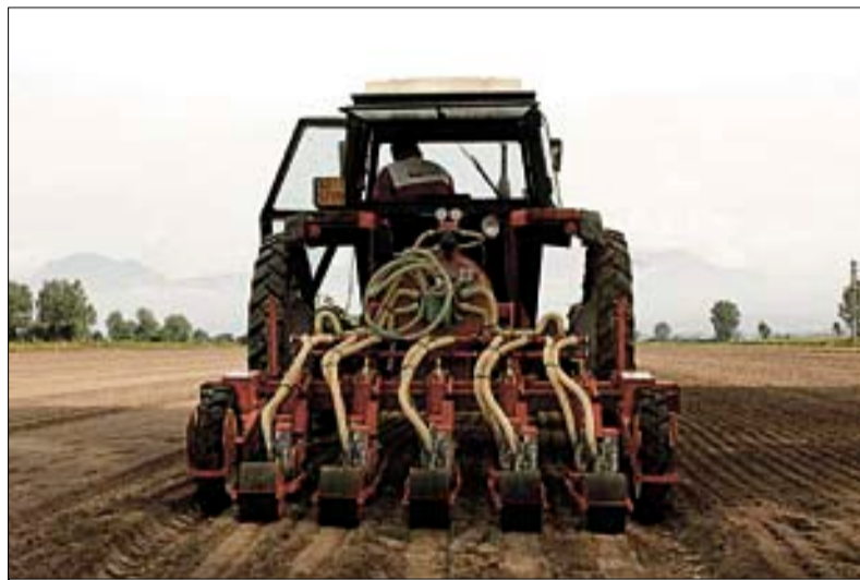
Овощная сеялка точного высева OLIMPIA
