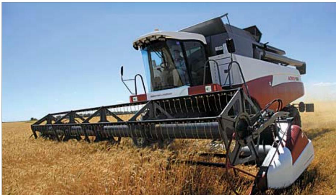
тамента отечественной сельхозтехники компании «Бизон». - К примеру, классическая однобарабанная молотилка обеспечивает лучшее сочетание высокой пропускной способности и низких энергозатрат. Зерновой бункер объемом 9000 л сокращает число остановок для выгрузки зерна. На разгрузку потребуются не более 2 минут. Гидропульсаторы на дне бункера позволяют выгружать зерно влажностью до 35%.
