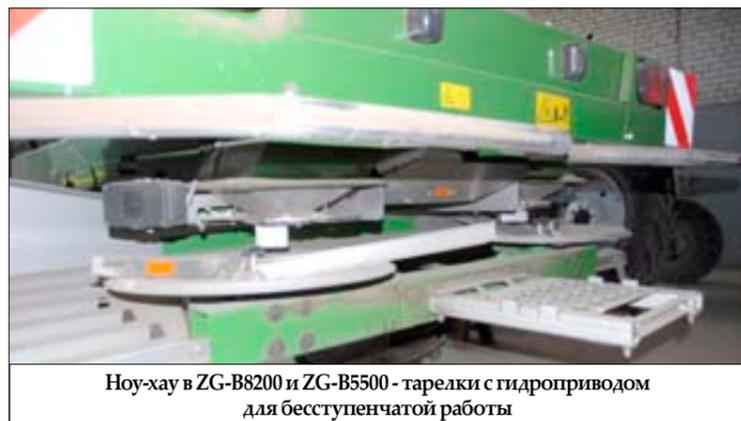
Ню-хау в ZG-B8200 и ZG-B5500 - тарелки с гидроприводом для бесступенчатой работы
