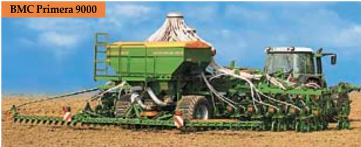
Что еще можно сказать об этом агрегате? Достоинство его еще и в том, что он может применяться как в крупных, так и в небольших хозяйствах, поскольку ширина захвата — от 3 до 12 м. В качестве дополнительной функции одновременно с посевным материалом могут вноситься удобрения. Словом, если вы приобрели сеялку компании Amazone DMC Primera 9001, то не ошиблись в выборе: техника отличная.
