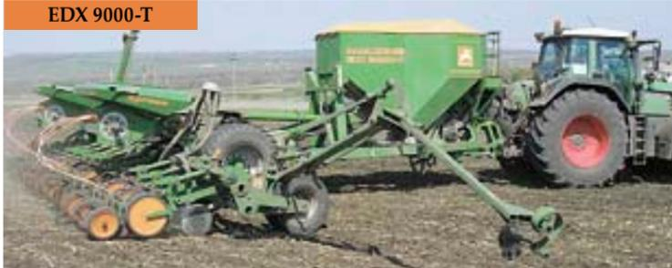
позиции «Агритехника», показывает прекрасные результаты. Сеялка точного высева EDX 9000-T может применяться как при традиционной технологии, так и при технологии мульчированного и прямого посева.
