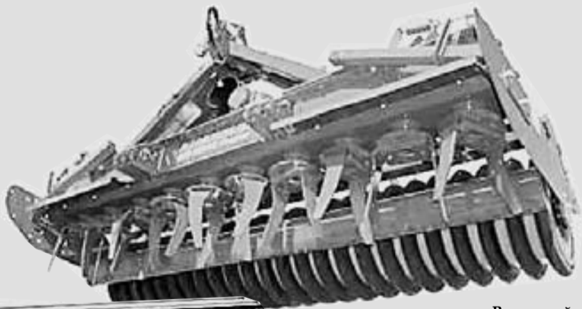
Роторный культиватор с зубьями с агрессивным углом атаки
