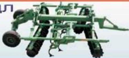
Диско-лаповые бороны серии БДЛ – почвообрабатывающие орудия для заделки растительных остатков на глубину до 20 см и одновременного рыхления почвы до 40 см. Передние диски измельчают остатки, два ряда лап проникают в почву для разрушения плужной подошвы, задние диски переворачивают и рыхлят землю, а также заделывают остатки. Сзади идет каток, который выравнивает и прикатывает грунт. Идеальная машина для обработки почвы под пашенные и технические культуры.
