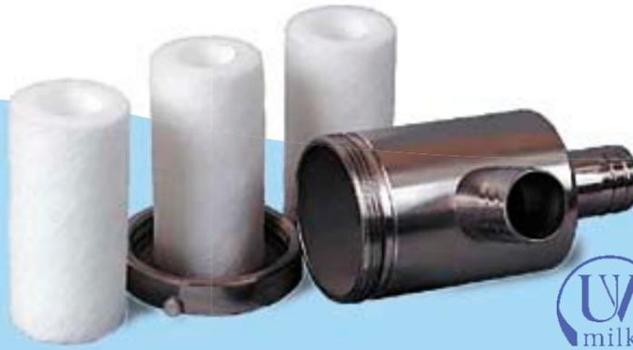
которых заполнено этими ворсинками. Когда молоко под давлением попадает в фильтр (максимальное рабочее давление при перекачке через фильтрующий элемент – до 25 атм.), массивные жировые шарики без труда раздвигают ворсинки и легко следуют по каналам, а более легкие грязевые частички застревают в канале.
