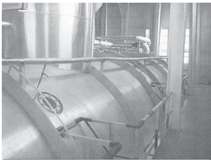
Вакуум-аппарат непрерывного действия для кристаллизации утфеля II фирмы «Фив-Кайл» (Франция) в ЗАО «Успенский сахарник»
