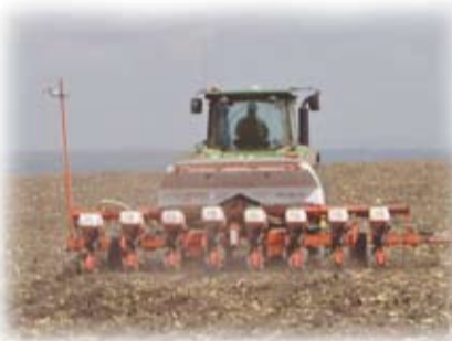
Сеялка пропашная для посева «по нулю», мульче и классике. От 6 до 12 рядов (4,2...8,4 м). С центральным бункером для удобрений на 950 или 1350 л
