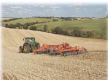
Дисковая борона «Дисковер ХМ», ширина захвата от 4 до 5,7 м. Работает как лузильник или тяжелая борона от 5 до 18 см. Сзади мощный и эффективный каток
