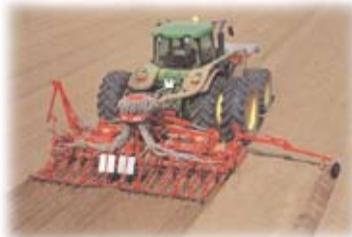
Комбинация пневматической сеялки «Вента» и фрезы НР шириной от 4 до 6 метров
