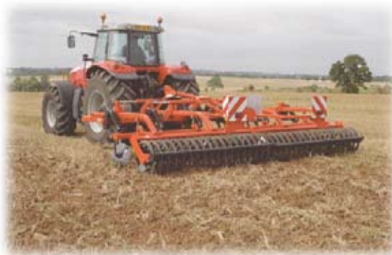
Чизель-культиватор. Ширина захвата 3,5, 6,5 и 8 метров, для тракторов от 120 до 500 л. с. Работает как культиватор на 5 - 12 см и как чизель на 25 - 30 см
