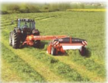
Прицепная косилка-плющилка FC 303 с вальцевой или битерной плющилкой с челночным косением на скорости до 25 км/ч
