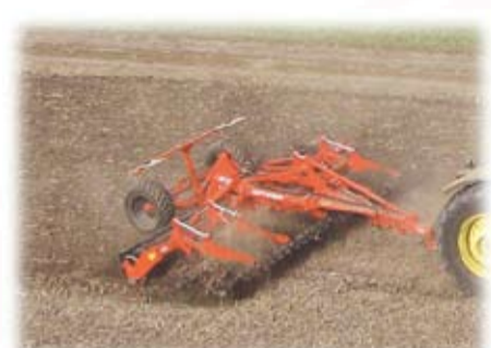
Скоростной дисковый лузильник «Оптимер» от 4 до 7,5 м для тракторов от 80 до 350 л. с. Сзади мощный и эффективный каток
