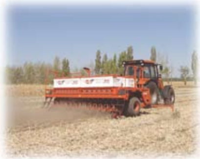
Сеялка зерновая механическая прямого посева СДМ. Ширина 4, 5 и 5,7 м, для тракторов от 120 до 230 л. с.
