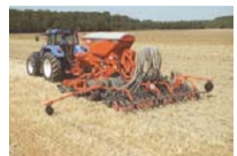
Комбинация пневматической сеялки «Вента» и фрезы НР шириной от 4 до 6 метров
