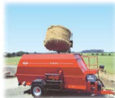
Прицепной миксер-кормосмеситель «Евромикс II» от 10 до 18 м³ с горизонтальными шнеками и выгрузкой на любую сторону в кормушку или кормовой стол. Большие колеса и компактный габарит
