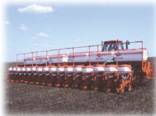
Сеялка прицепная пропашная «ПДМ Максима» 16 рядов (11,2 м) с фронтальными бункерами для удобрений
