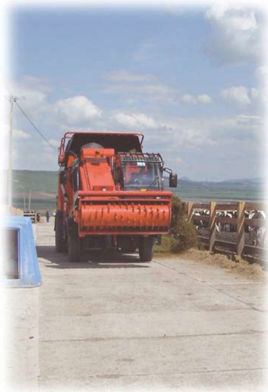
Самоходный миксер-кормораздатчик SPH 14 на ферме в России. Самозагрузка всеми компонентами, быстрое смешивание без переизмельчения. Разгрузка в кормушку или на кормовой стол
