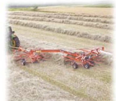
Прицепная ворошилка GF 1701 рабочей шириной 17 м и транспортной 3 м
