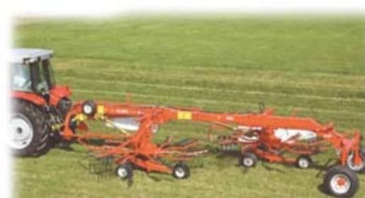
Валкообразователь GA 6020 (8020) шириной 6 или 8 метров, для формирования валков каждым ротором отдельно сдвоенного или счетверенного с 11 (15) метров
