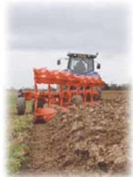
Плуг полуприцепной оборотный «Менеджер» от 5 до 8 корпусов, агрегируется с тракторами мощностью 180...350 л. с. по схеме «трактор в борозде»
