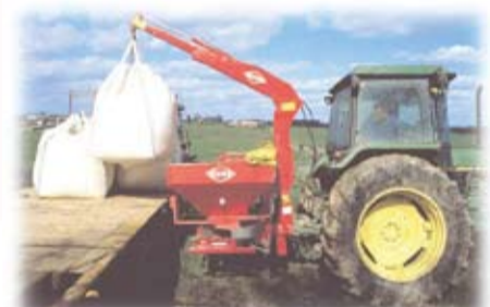
Манипулятор «Левсак» в агрегате с разбрасывателем МДС или «Аксис». Грузоподъемность 1 тонна (биг-бэг). Емкость бункера от 900 до 3000 литров. Для тракторов от 120 до 230 л. с.
