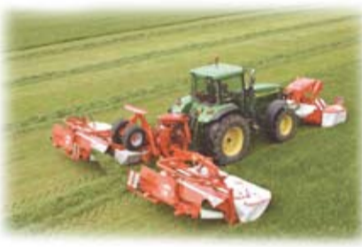
Комбинация навесных косилок с автоматом высоты и транспортерами для формирования супервалка под самоходный комбайн с шириной 8 или 9 метров
