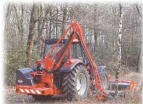
Манипулятор с тремя вариантами измельчительной головки для травы, веток и кустарников или дисковые пилы для тракторов от 120 до 230 л. с.
