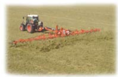
Прицепная ворошилка GF 1701 рабочей шириной 17 м и транспортной 3 м
