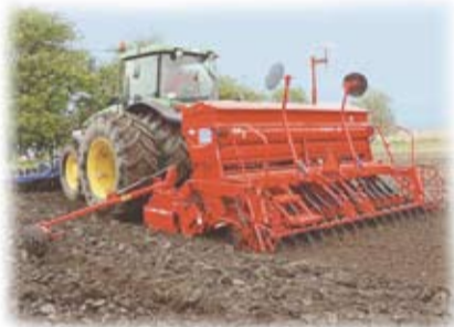
Комбинация сеялки «Интегра» и фрезы НР от 3 до 4 м, для тракторов от 180 до 280 л. с. Для посева всех зерновых и особенно зеленого горошка
