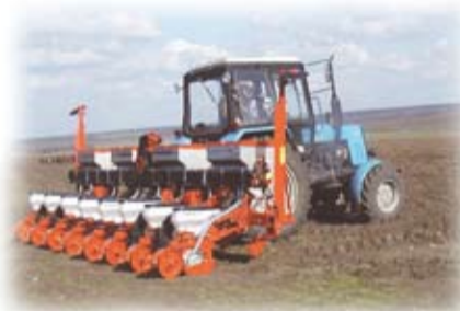
Сеялка пропашная «Плантер 2» от 5,6 до 9 м (8 - 12 р. на 70 или 12 - 18 на 45 см) для посева сахарной свеклы, рапса, сои, кукурузы и подсолнечника, для тракторов от 80 до 150 л. с.
