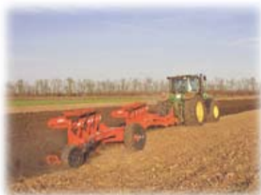
Плуг полуприцепной оборотный «Челленджер» от 8 до 13 корпусов для тракторов от 270 до 500 л. с. как в борозде, так и вне борозды
