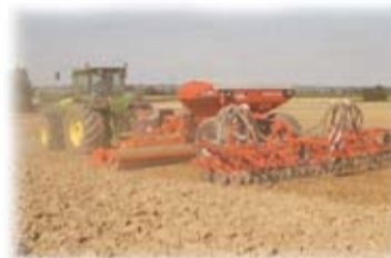
Комбинированная модульная сеялка «Модулайнер» от 4 до 6 м, для тракторов от 180 до 350 л. с.
