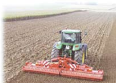
Вертикально фрезерный культиватор НР, ширина захвата от 2 до 6 метров, для тракторов от 80 до 350 л. с. Как отдельно, так и в комбинации с сеялками
