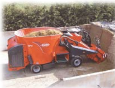
Самоходный миксер-кормосмеситель SPV с вертикальным шнеком от 10 до 18 м³ с выгрузкой через фронтальный реверсивный транспортер
