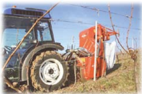
Измельчитель лозы TRP с подъемником лозы, подающим барабаном и ротором-измельчителем, с разбрасывателем междурядья или сбором в мешок
