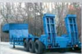
ПОЛУПРИЦЕП ЧМЗАП-999000-073-01, 60 т., 9190×2500 (3150) мм, погруз. высота 1225 мм.
