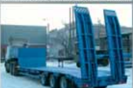
ПОЛУПРИЦЕП ЧМЗАП-990640-052МТ2, 38 т., 9300×2500 (3000) мм, погруз. высота 885 мм.
