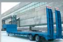
ПОЛУПРИЦЕП ЧМЗАП-938530-037УУБ2, 24 т., 11400×2500 (3000) мм, погруз. высота 885 мм.
