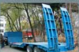
ПОЛУПРИЦЕП ЧМЗАП-938530-037НРК, 25 т., 6000×4000×2500 (3000) мм, погруз. высота 630 мм.
