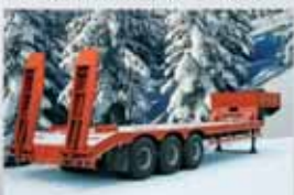
ПОЛУПРИЦЕП ЧМЗАП-999000-052, 52 т., 9310×3150 мм, погруз. высота 1350 мм.
