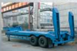
ПОЛУПРИЦЕП ЧМЗАП-99865-01-012, 39,4 т., 7480×3150 мм, погруз. высота 1170 мм.
