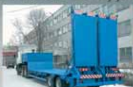
ПОЛУПРИЦЕП ЧМЗАП-93853-030, 24 т., 7600×2500 (3000) мм, погруз. высота 885 мм.
