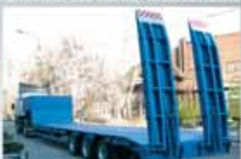
ПОЛУПРИЦЕП ЧМЗАП-990640-042-02, 38 т., 11800×2500 (3000) мм, погруз. высота 885 мм.
