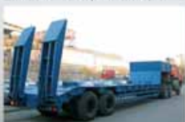
ПОЛУПРИЦЕП ЧМЗАП-99865-01-053, 41 т., 10070×2500 (3000) мм, погруз. высота 1225 мм.
