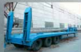
ПОЛУПРИЦЕП ЧМЗАП-990640-070, 39,8 т., 10000×3000 мм, погруз. высота 1200 мм.
