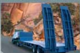
ПОЛУПРИЦЕП ЧМЗАП-93853-030МТУ, 24 т., 8400×2500 (3000) мм, погруз. высота 885 мм.
