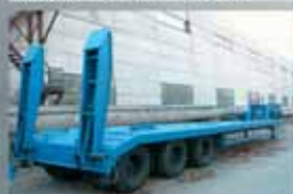
ПОЛУПРИЦЕП ЧМЗАП-990640-070, 39,8 т., 10000×3000 мм, погрузка, высота 1200 мм.
