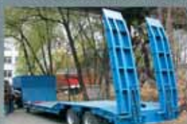
ПОЛУПРИЦЕП ЧМЗАП-938530-037HPC, 25 т., 6000×4000×2500 (3000) мм, погрузка, высота 630 мм.
