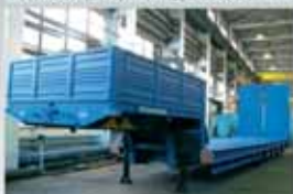
ПОЛУПРИЦЕП ЧМЗАП-990640-046, 37 т., 11800×3000 мм, погрузка, высота 885 мм.
