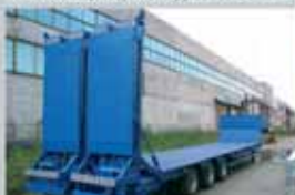
ПОЛУПРИЦЕП ЧМЗАП-990640-042, 35 т., 11800×2500 (3000) мм, погрузка, высота 885 мм.
