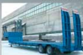
ПОЛУПРИЦЕП ЧМЗАП-938530-037УУБ2, 24 т., 11400×2500 (3000) мм, погрузка, высота 885 мм.
