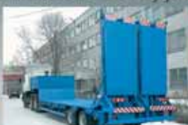
ПОЛУПРИЦЕП ЧМЗАП-93853-030, 24 т., 7600×2500 (3000) мм, погрузка, высота 885 мм.
