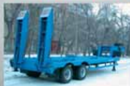
ПОЛУПРИЦЕП ЧМЗАП-93853-033, 26,2 т., 7600×2500 мм, погрузка, высота 885 мм.
