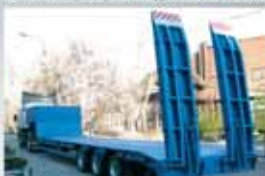
ПОЛУПРИЦЕП ЧМЗАП-990640-042-02, 38 т., 11800×2500 (3000) мм, погрузка, высота 885 мм.
