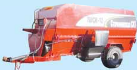
ПИСК-12 - прицепной измельчитель-смеситель-кормораздатчик
