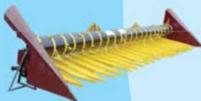
ЛИФТЕР – приспособление для уборки подсолнечника на жатки всех моделей зерноуборочных комбайнов
