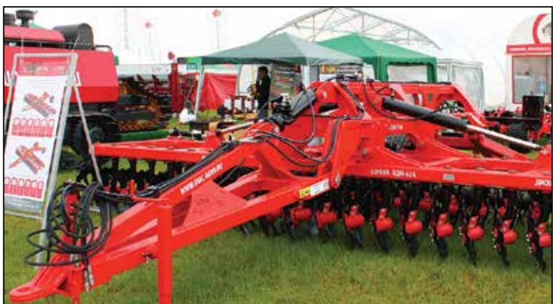
Подприцепная борона БДМ-6х2Б особенно эффективна при предпосевной обработке по минимальной технологии, а также при лущении стерни, выравнивании зяби и уничтожении сорняков
