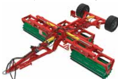
Измельчитель ротационный ИР-6.1 предназначен для измельчения растительных остатков
