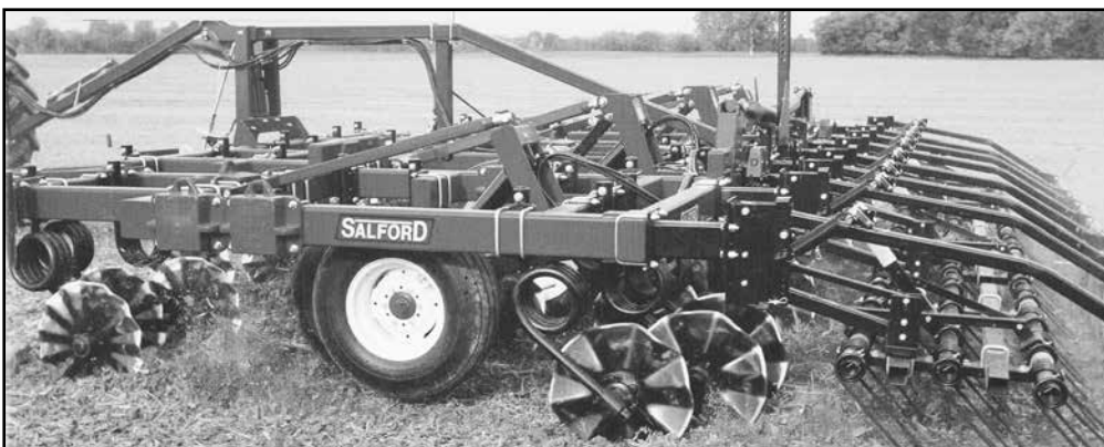
Фото 1. Турбокультиватор RTS — специалист по обработке растительных остатков. Механизм вертикальной обработки почвы
