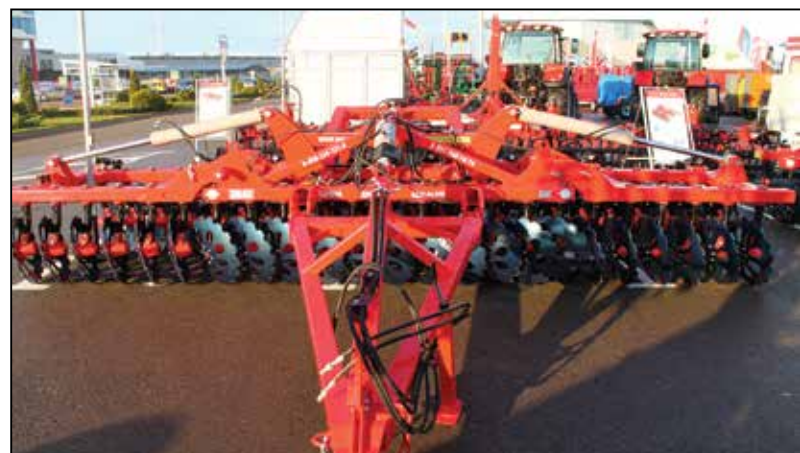
Борона полуприцепная секционная БДМ-6х2ПК для основной и предпосевной обработки почвы по минимальной технологии, лущения стерни и уничтожения сорняков
