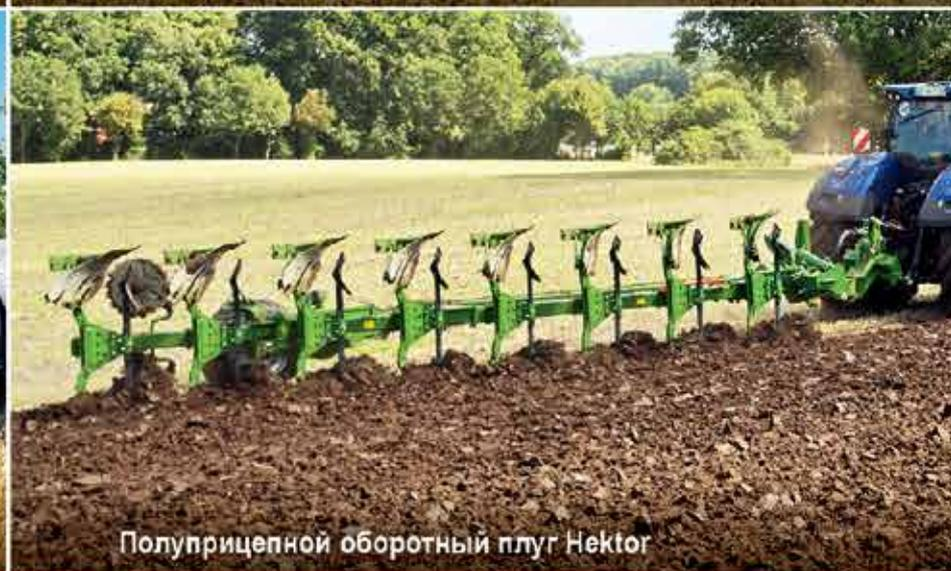
Полуприцепной оборотный плуг Нектор
