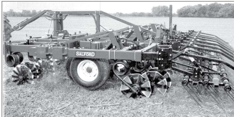
**Фото 1. Турбокультиватор RTS – специалист по обработке растительных остатков. Механизм вертикальной обработки почвы**
