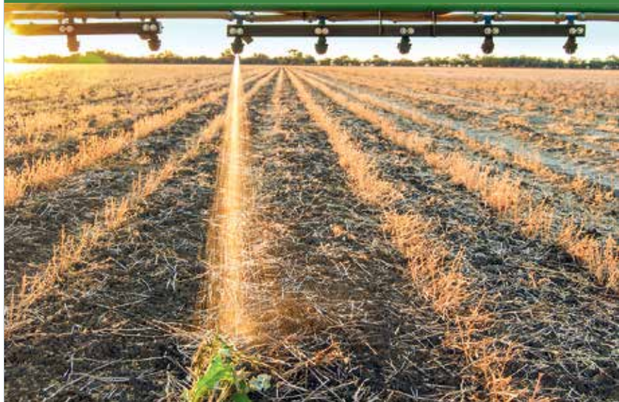
Система сенсорных форсунок AmaSpot
