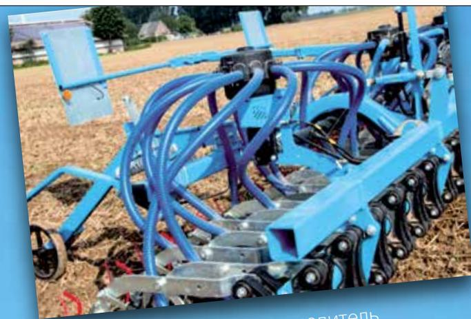
Новая разработка – распределитель с интегрированным переключением технологической колеи
