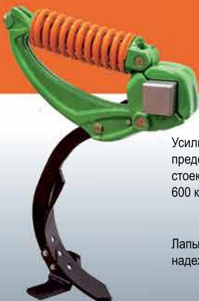
Усилие срабатывания пружинного предохранительного механизма стоек C-Mix-Super составляет более 600 кг с ходом пружины 300 мм.
