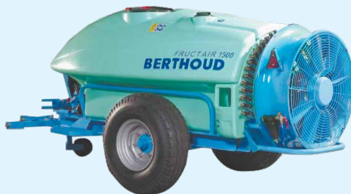
Прицепной пневматический опрыскиватель BERTHOUD FRUCTAIR TCI 1500
