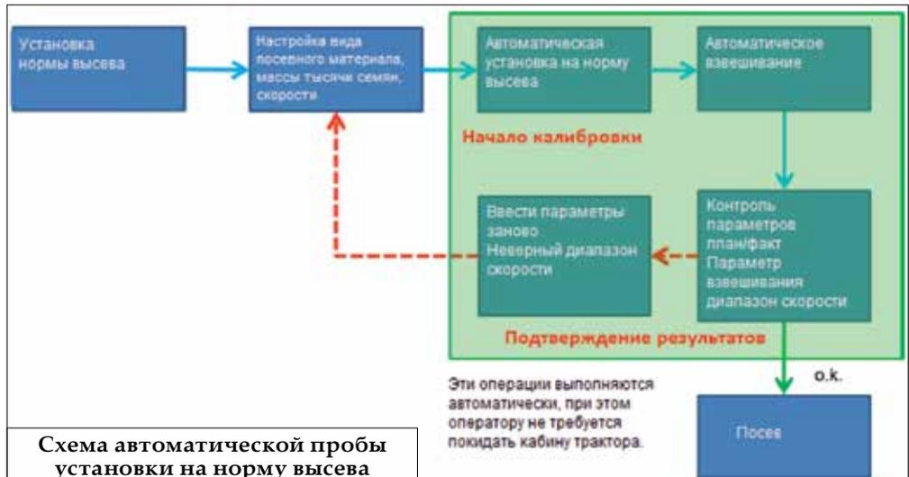
Схема автоматической пробы установки на норму высева
