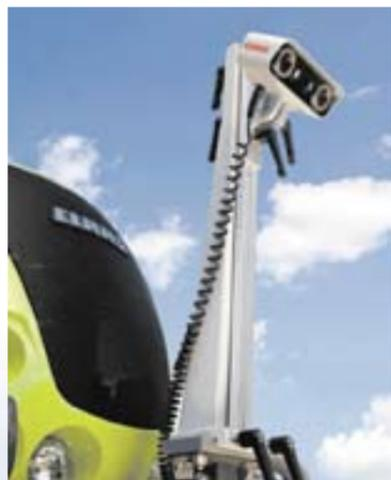
Оптический автопилот предназначен для автоматического ведения трактора по междурядью с точностью 2 - 3 см. Операции для пропашных и овощных культур: посев/посадка, опрыскивание, междурядная обработка, уборка.
