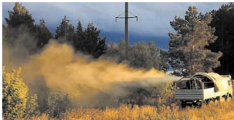
**ЗА СЧЁТ** совмещения в одном механизме функций аэрозольного генератора регулируемой дисперсности и дистанционно-го мелко- и крупнокапельного опрыскивателя ГАРД обладает возможностью применения пестицидов в аэрозольном режиме. Шкала диапазона дробления капель – от 3 до 50 мкм, в режиме УМО – от 50 до 100 мкм, в режимах мелкокапельного – от 100 до 300 мкм и крупнокапельного опрыскивания – от 200 до 400 мкм, с плавной или ступенчатой регулировкой капель рабочей жидкости.
