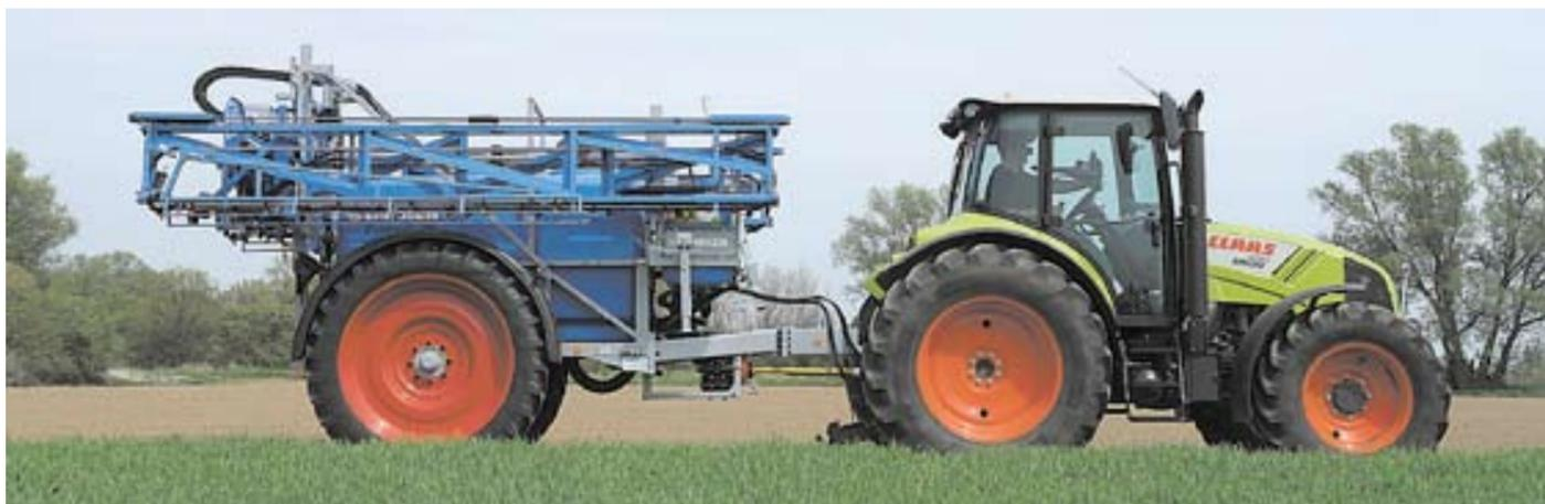
«Примусе 25» используется один насос производительностью 250 л/мин; у «Примуса 35» имеется 2 насоса каждый производительностью 160 л/мин, а суммарно – 320 л/мин; у «Примуса 45» – 2 насоса производительностью 250 л/мин каждый, итого 500 л/мин.
