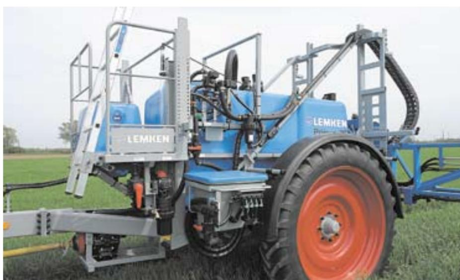
виды управления в зависимости от потребностей клиента. В стандартную комплектацию входит компьютер TeeJet 844 E или Spraudos от фирмы «Мюллер», включающий циркуляционную систему для рабочего раствора, как опция.
