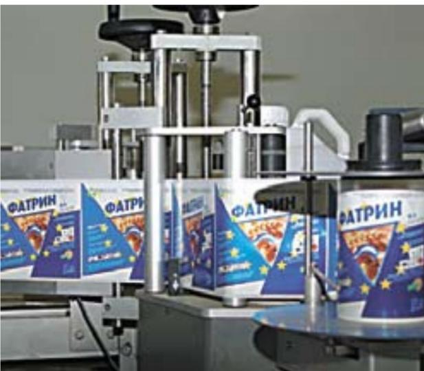
Автоматическая фасовочная линия с закупориванием крышек, нанесением этикеток и маркировки завода «Берлуга КФТ»
