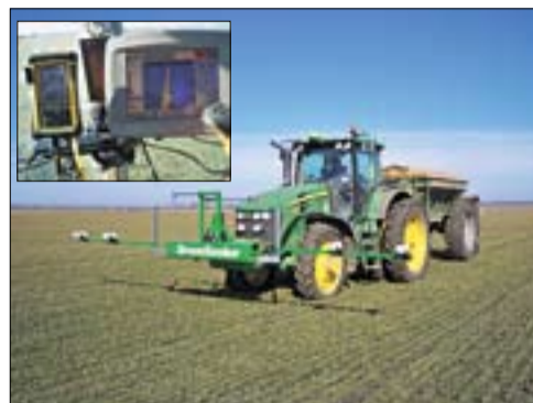
Бортовой компьютер автоматически изменяет норму удобрений согласно карте дифференцированного внесения, составленной в программе «Аграр-Офис»
