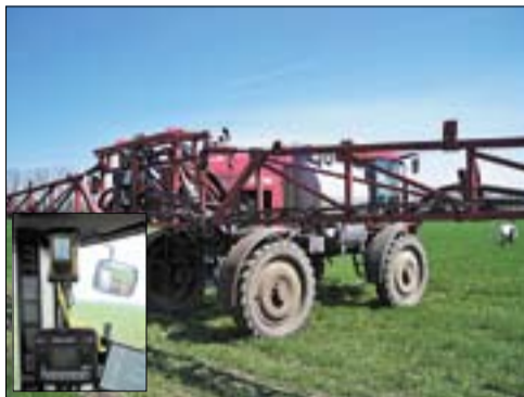
При движении по полю сенсорные датчики сканируют биомассу растений по индексу NDVI и полученную информацию передают в бортовой компьютер, который управляет нормой вносимых азотных удобрений в режиме реального времени
