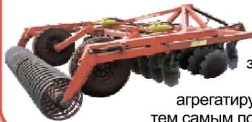
Предназначена для поверхностной обработки почвы (до 15 см). Отличается от 4 рядных дискаторов уменьшенным междисковым расстоянием в ряду 300 мм и увеличенным расстоянием между рядами дисков (900 мм) что исключает забивание пожнивными остатками. За счет снижения тягового усилия трактор агрегатируется с боронкой большей ширины захвата, тем самым повышается производительность на 20-50%
