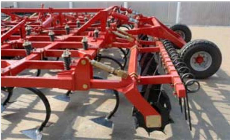
м работы, что улучшает крошение почвы. Мощные стрелчатые лапы шириной захвата 370 мм и чизельные рабочие органы шириной 178 мм.
