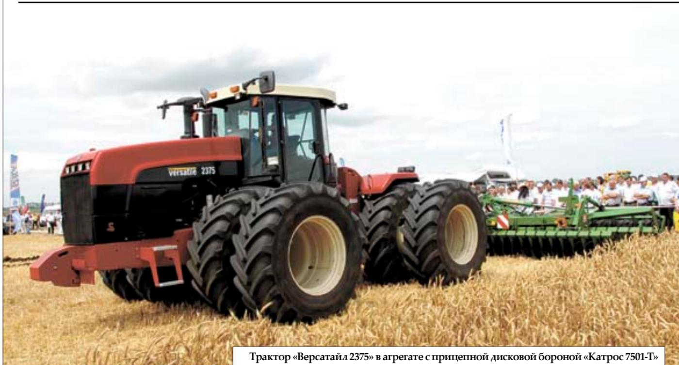
Трактор «Версатил 2375» в агрегате с прицепной дисковой бороной «Катрос 7501-Т»
