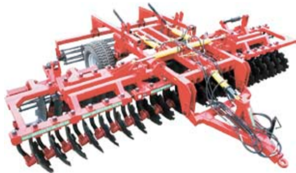
Борона дисковая двухрядная БДП-6х2
