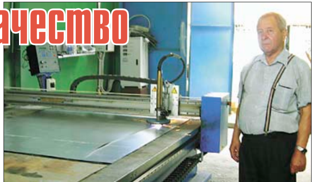
Директор ООО «Бас В» Вадим Басок демонстрирует работу нового управляемого автоматизированного станка плазменной резки листовых материалов, недавно установленного на предприятии
