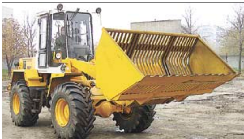
Шасси погрузочное многофункциональное серии АМКОДОР 332С4 с ковшом для свеклы
