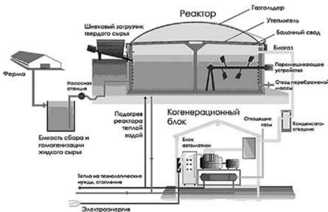
Принципиальная схема биогазовой установки промышленного типа (www.zorg.ua)
