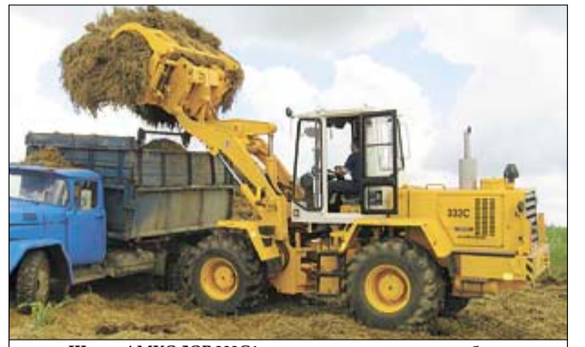
Шасси АМКОДОР 332С4 с вилами с прижимом в работе
